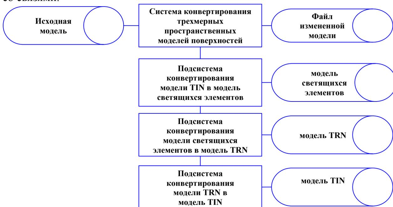
**Рисунок 2 - Функциональная схема метода конвертирования трехмерных пространственных моделей поверхностей.**
