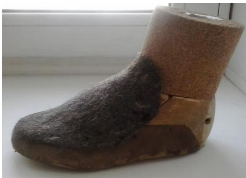
Рисунок 3 – Колодка на паралитическую стопу (на основе аппаратной).
